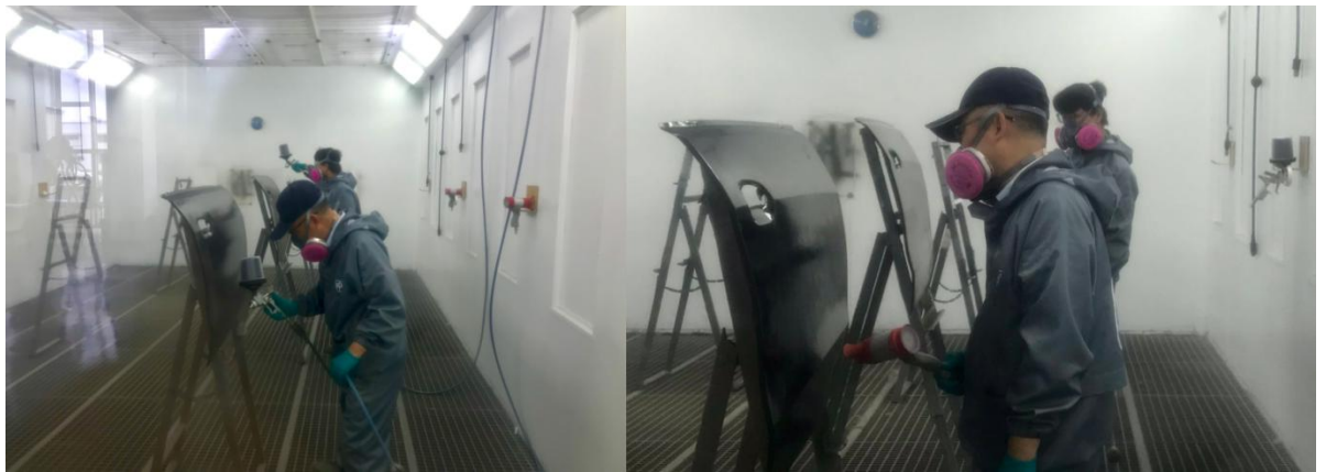
图 2.6 水性色漆喷及烘干工序涂实景
