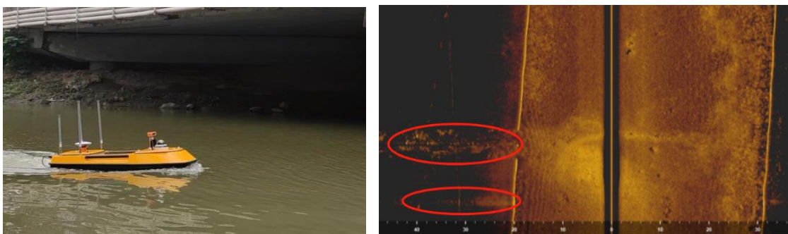
图5 入河（海）排污口技术排查-无人船侧扫声呐排查图
