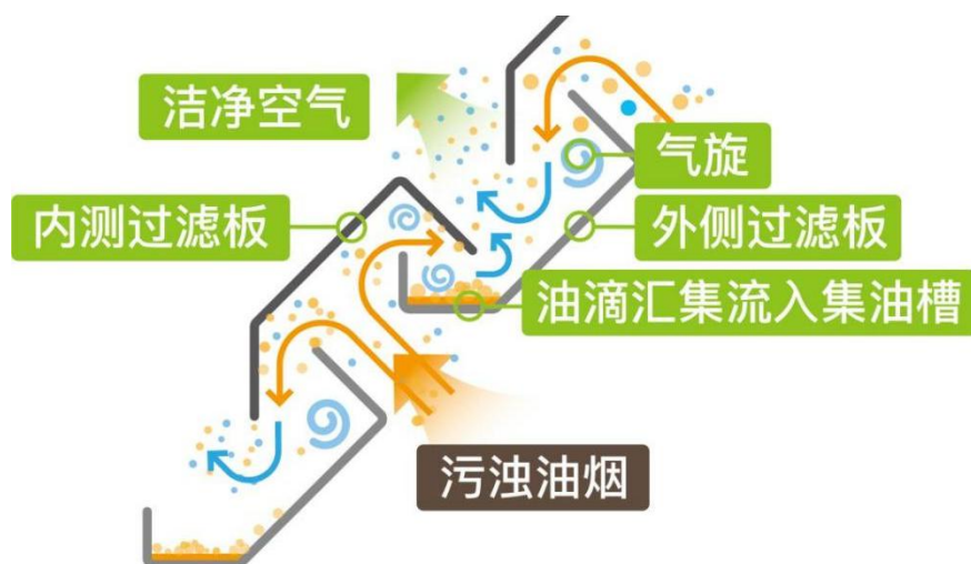
图 A.1 机械过滤器原理示意图
